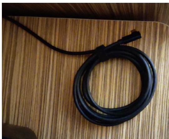
Рис. 3. Приклад закріпленого кабелю, що використовується для підключення до VR-гарнітури, довжиною 5 метрів, з можливістю передачі даних зі швидкістю 10Гбіт/с (стандарту USB 3.1 Gen 2) та потужністю живлення 10.5W (ват, тобто силою струму заряджання 2.1А, при напрузі 5В)
