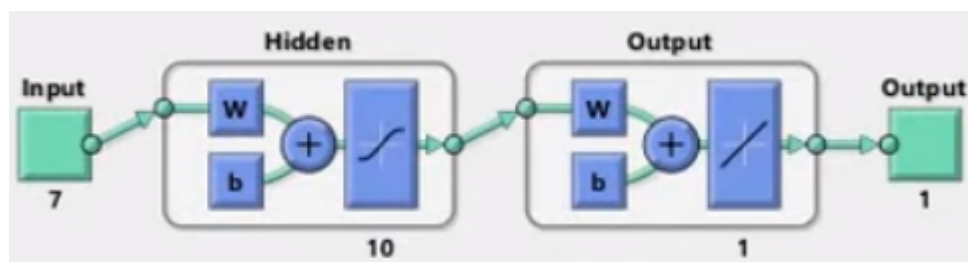
Рис. 2. Архітектура двошарової ШНМ в MATLAB
