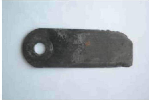
Рис. 1. Характерне зношування ножа соломоподрібнювача при досягненні граничного напруцювання
