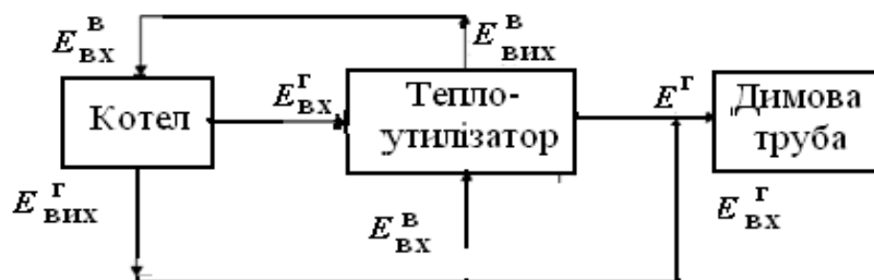
Рис. 1. Структурна схема котельної установки з теплоутилізатором при застосуванні методу байпасування димових газів для захисту газовідвідних трактів
