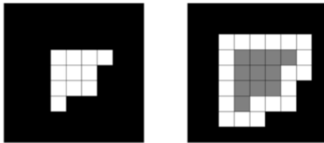
Рис. 1. Область розширюється на 1 піксель. Сірі пікселі на правому малюнку показують вихідну нерозширена область для порівняння
