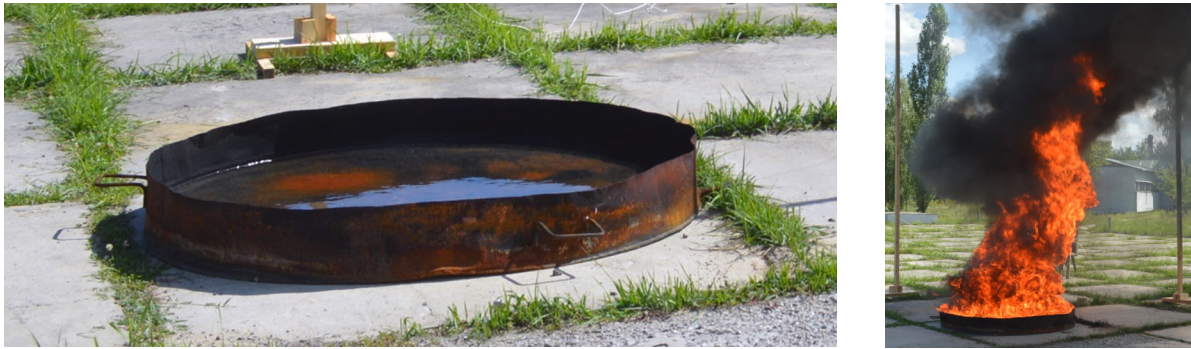
Рис. 2. Модельне вогнище для створення факелу пожежі
