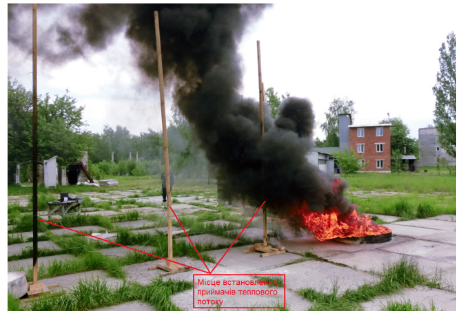
Рис. 3. Улаштування модельного вогнища та приймачів теплового потоку
