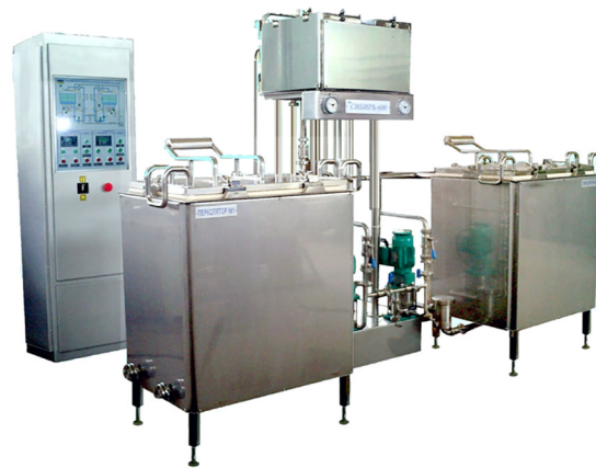
Рис. 1. Принципова схема установки для екстрагування БАР з рослинної сировини «Сибір-600»
