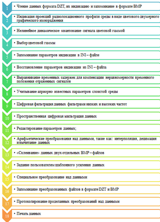
Рис. 3. Методы восстановления радио изображений, обработки сигналов и изображений подповерхностной области и объектов
