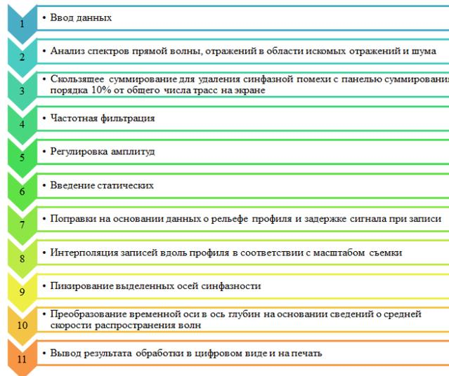
**Рис. 1. Последовательность обработки геофизических данных**
