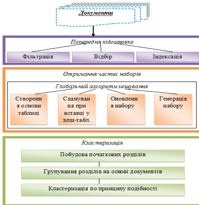
Рис. 1. Структурна схема процесу кластеризації веб-документів на основі алгоритму хешування для отримання частих наборів
